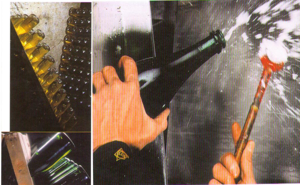
Şəkil 3. Remyuaj və deqorjaj prosesi
