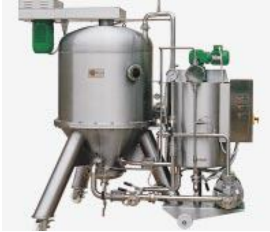
Şək. Yaxma diatomit filtri “Qrinfiltr”
