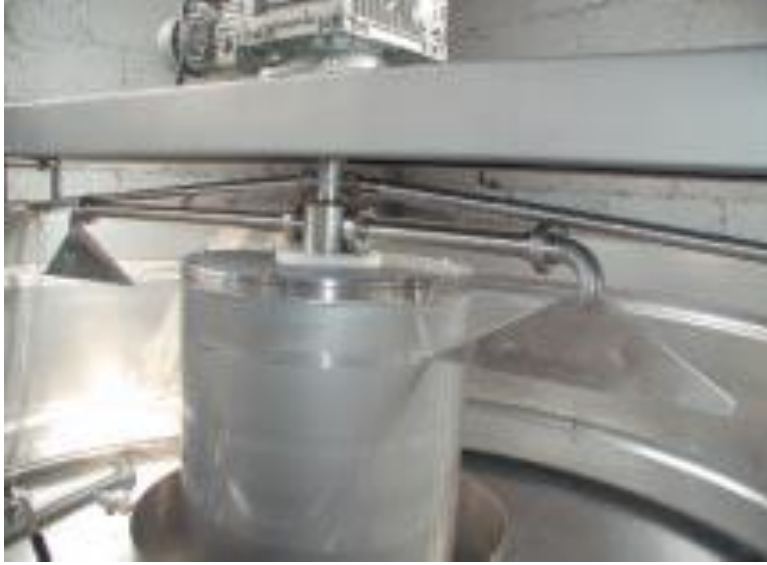
Şək. Asılqanları kənar etmək üçün flotator qurğusu
